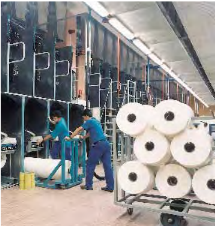
Schnellspinnmaschine zur Herstellung von Polyester- oder Polyamidgarn der barmag AG in der Türkei.
